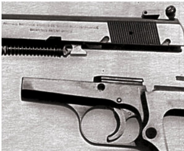
Faire glisser la glissière vers l'avant et séparer de la carcasse
